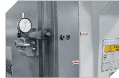
Derinlik kontrol saat aparatı(saat hariç) ve sınır siviçleri Depth dial gauge control apparatus(except dial-gauge) and limit switches
